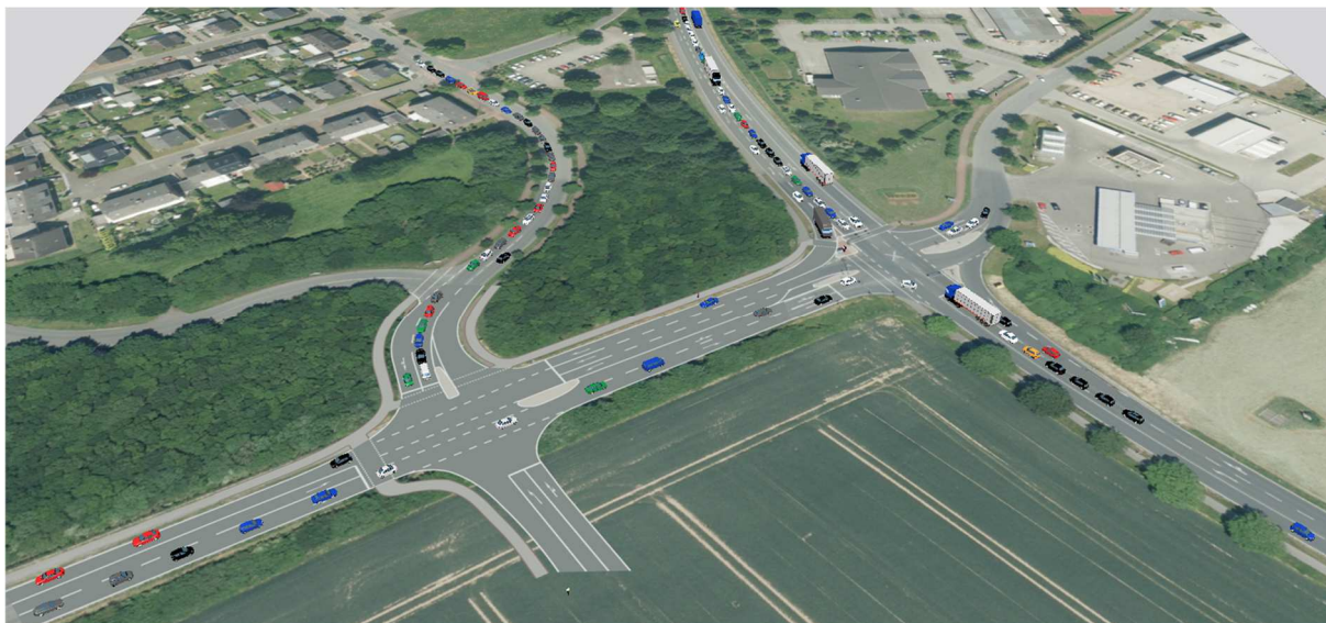
Abbildung 24: Mikrosimulation Variante 6 – Doppel-LSA „einfacher Ausbau“
